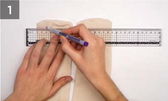
Con la ayuda de un rotulador fantasma marcaremos las líneas de corte, tanto en el extremo final de la media, como en el largo de la pierna. Este tipo de rotulador nos permitirá dibujar de forma temporal sobre el tejido (la tinta desaparece a los 5 días o bien en contacto con el agua).
