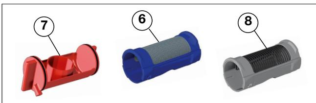
El filtro en dotación (color azul) está constituido por una red metálica que filtra partículas de diámetro superior a 0,3 mm. Esta malla filtrante específica permite bloquear todas las partículas que permanecen en circulación, cumpliendo la operación de primera limpieza de los tubos. Una vez interceptado y vaciado DIRTMAGPLUS®, el filtro (6) es fácilmente inspeccionable para realizar las siguientes operaciones:
