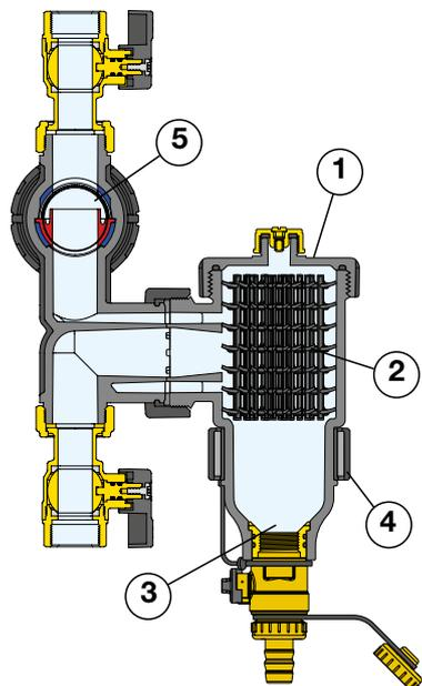
2. Un filtro de cartucho intercambiable (5) que bloquea mecánicamente las impurezas contenidas en el líquido caloportador. El filtro de cartucho retiene las impurezas mediante la selección mecánica de las partículas en base a su tamaño, a través de una malla filtrante específica de red metálica.
