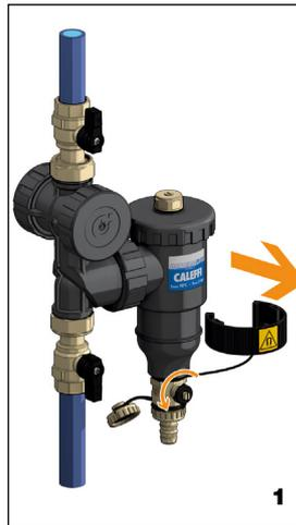
Quitar el anillo donde están alojados los imanes (fig. 1) y purgar las impurezas, aun con la instalación en funcionamiento, utilizando la llave en dotación (fig. 2).
