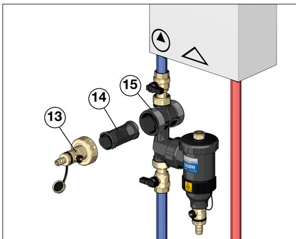
El kit accesorio de llenado y lavado del circuito (Cód. F49476) se compone de un tapón con un grifo de descarga (13) y un elemento de color negro (14) que se coloca en el recipiente del filtro (15) para la separación de los flujos.
