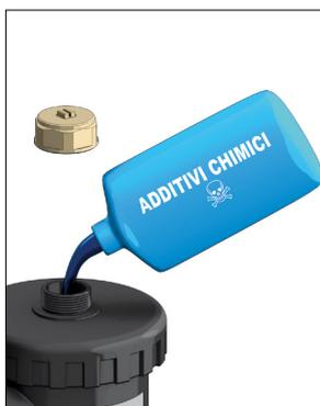
El dispositivo multifunción se puede utilizar también como punto de acceso para la introducción en el circuito de aditivos químicos, con el fin de proteger la instalación.
