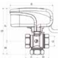
Válvula de zona motorizada con tapón obturador
