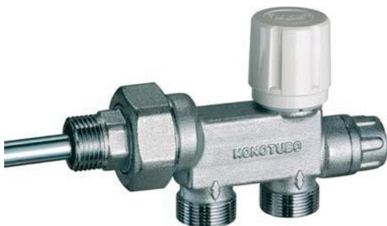
Las válvulas monotubo termostaticables permiten el ajuste manual, térmico o eléctrico. El detentor independiente permite un perfecto equilibrado de la instalación y regular el paso de caudal a través del bypass, así como permitir un cierre completo de la válvula para sus substitución. La válvula es reversible, es posible conectar las tuberías indistintamente sea la ida o el retorno.
