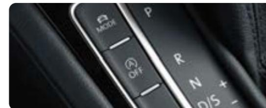
La selección de perfil de conducción permite un ajuste individualizado al tipo de conducción deseado, regulando la firmeza de la dirección, los parámetros del motor y del cambio de marchas, así como el control adaptativo de la velocidad y las luces de giro. Los cinco diferentes perfiles permiten regular la conducción y la dinámica del vehículo a modo "NORMAL", "ECO", "SPORT", "COMFORT" e "INDIVIDUAL".
