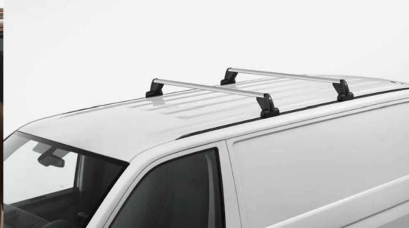
ANCLAJE CON BARRAS LONGITUDINALES DE TECHO
