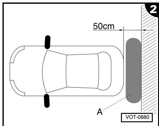
Ertönt nach dem Einlegen des Rückwärtsganges kein Signalton, muss eine Fehlersuche durchgeführt werden.
