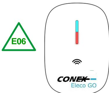
Si el indicador LED está fijo en color cian y la parte inferior parpadea en color rojo no se ha detectado el sensor de corriente MODBUS.
