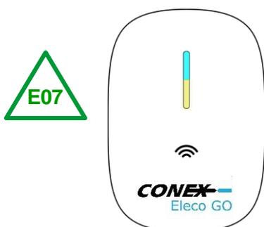
Si el indicador LED está fijo en color cian y la parte inferior parpadea en color amarillo indica que no hay suficiente corriente para cargar el vehículo.
