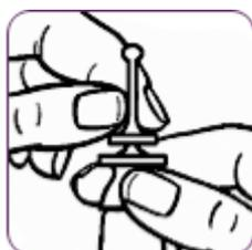
**Paso 2:** Con la otra mano, presione hacia abajo sobre el disco pequeño hasta que los 2 discos se junten. Así se perforará el sello.
