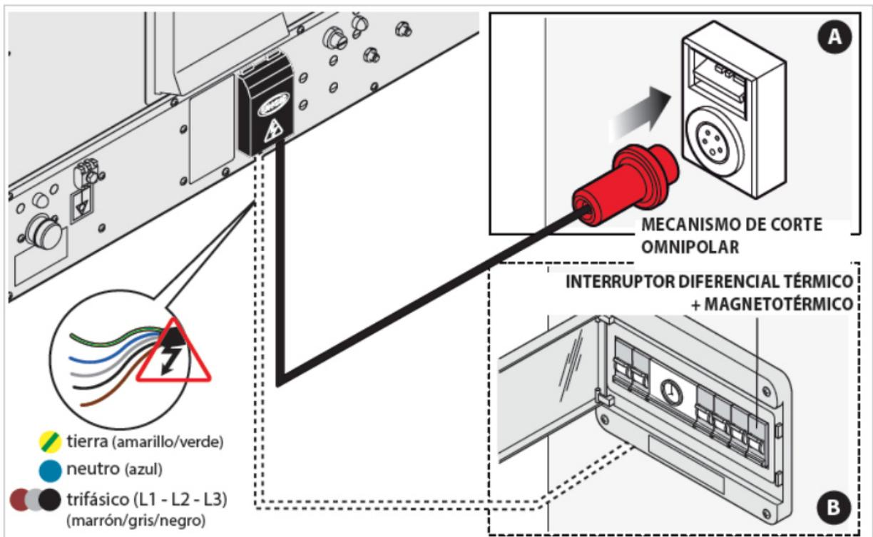
En el caso de querer conectar a monofásico 230v. Hay que sustituir la manguera de 5 cables por una de 3 cables del grosor necesario según los amperios de consumo y colocar un cetac monofásico. 1N1L Siempre debe estar conectado el horno a Toma tierra ya un mecanismo de corte omnipolar.
