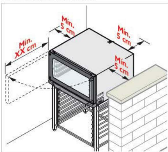
Coloque el aparato dejando las distancias indicadas en las figuras, de manera que se pueda acceder fácilmente a la pared trasera para realizar las conexiones y las operaciones de mantenimiento.
